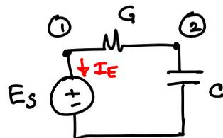
Given  $E_s(t)$  find  $V_1(t)$ ,  $V_2(t)$ ,  $I_E(t)$
