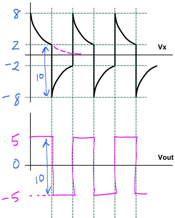
$$\frac{2}{8} = e^{-\frac{t_1}{RC}} \rightarrow t_1 = RC \ln(4)$$
